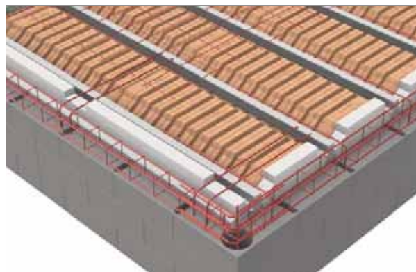
Plancher EBS avec rupteur Total : Stoptherm EB
